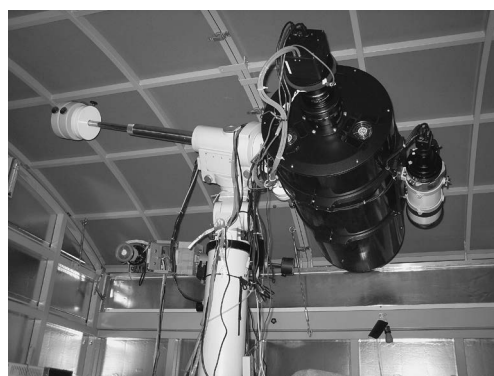
写真3 36 cm F8反射望遠鏡（2011年）。
