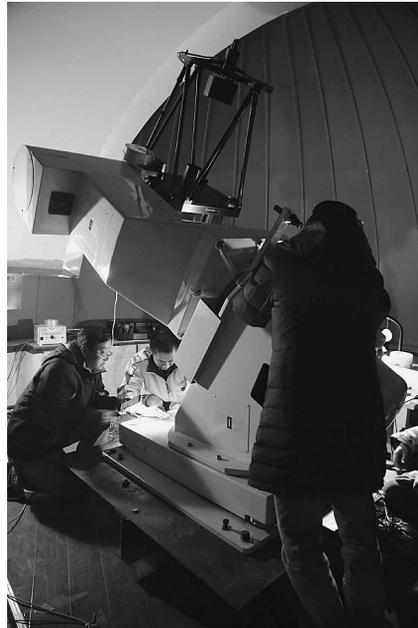
図5 極軸望遠鏡を取り付け極軸調整中のHinO-TORI望遠鏡。
