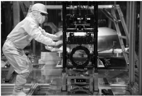
図13 KAGRAの概略図(上)と防振装置に取り付け作業中のサファイア鏡(下)(出典上:東京大学宇宙線研究所,下:東京大学 https://www.u-tokyo.ac.jp/focus/ja/features/z0508_00110.html tokyo.ac.jp/focus/ja/features/z0508_00110.html).
