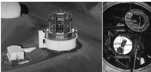
図9 すばる望遠鏡（左）と主焦点に搭載された広視野カメラ Suprime-Cam（右）（クレジット：国立天文台）。
