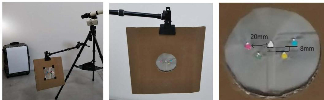
図2 撮影の装備 (左) と使用したピンホール板 (中央), ピンホールの配置 (右).
