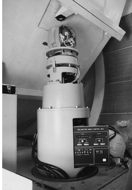
写真2 コリメーター室内部の写真(国立天文台提供)。真ん中の円錐状の物がマスターコリメーター、左が主鏡のセンターハブ側でそこに小さな平面鏡がついている。
