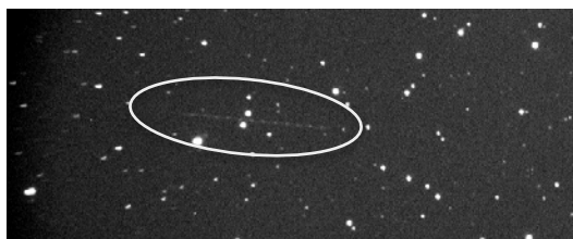
図1 NORAD 番号 38690 2016年12月18日00時25分10秒~20秒（露出10秒）岡山県美星天文台101cm反射望遠鏡フォーカス赤道儀恒星時追尾 f=606cm、STL1001E 冷却 CCD カメラ、0.1度×0.04度をトリミング
