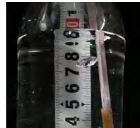
図3 水中を上昇する気泡(水面近く下から38cm程)。ペットボトルを3本繋げたものに水をため、メジャーとストローを入れた。
