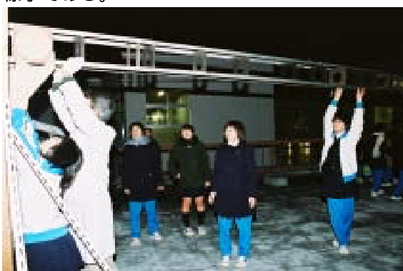
図 - 9 望遠鏡を架台に載せるところ 支点が低いとはいえ、高さ 1.9m の位置にあるので組み立ては大変である。
