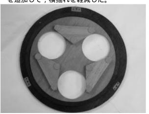
た。主鏡を押さえる枠は,最初 2mm 厚の薄い合板をサークルカッターでドーナツ状に切り出し,6カ所 4mm のボルトで固定したが,敢え無く破損してしまった。そこで,ジュラルミンのリングを特注し,それで押さえることにした。ただ,硬いジュラルミンで直接鏡を押さえると歪むので,1mm厚のコルクを貼ってある。
