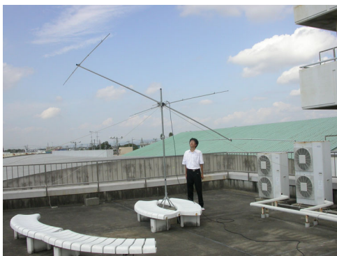
写真2 銀河電波望遠鏡2号機（八木アンテナ型機）
