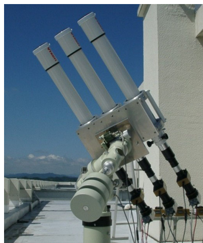
図1. 米子高専の太陽彩層速度場観測望遠鏡
