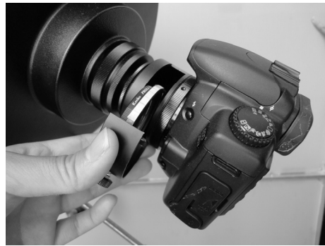
図1 接眼部にセットした偏光フィルター
