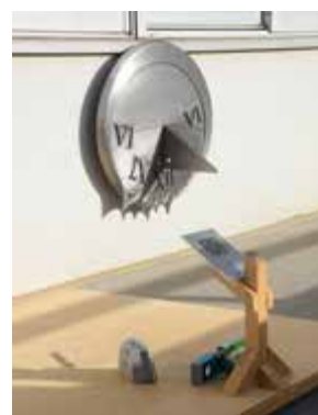
図3 太陽像の位置を記録して正確な方位を調べる装置 設置前の日時計を窓枠にかけて、装置と一緒に撮影した。
