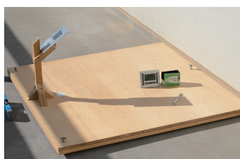
図1 太陽の動き観測装置
