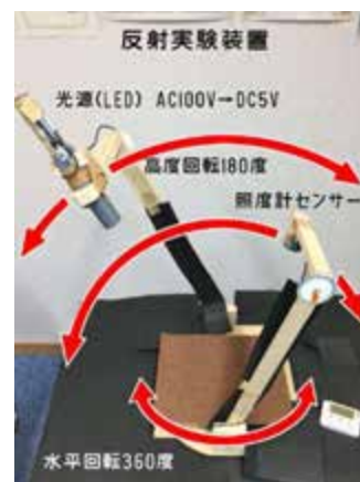
図-4 自作の反射実験装置
