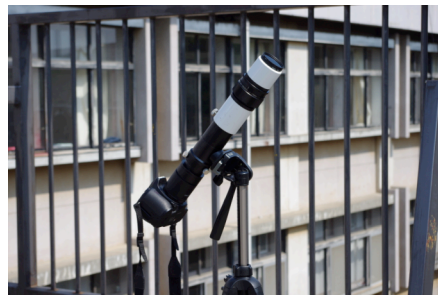
図2 観測に使用したデジタル一眼レフと望遠鏡
