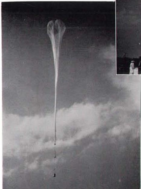
(上)は放球準備中で水素をつめ終ったところ、(中)は放球の瞬間、(下)は放球直後上昇中の気球。全長約90mで、下端に動揺計、気圧計等の観測器がついている。
