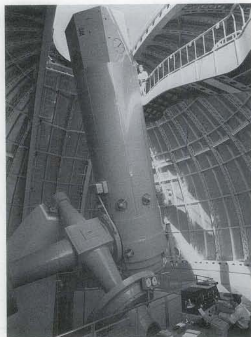
▲ 193 cm 望遠鏡, 岡山の 188 cm 鏡と同じグループ・パーソンズ社製. 筒を二重に張ってファンで空気を吸い筒内の乱流を防いでいる.
