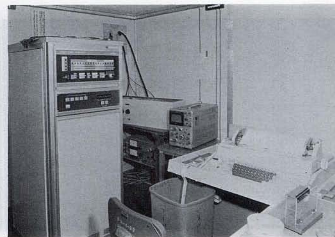
⑤ 計算機室の内部。奥の机上にある横長の箱に光電子計数装置と計算機への接続回路が入っている。
