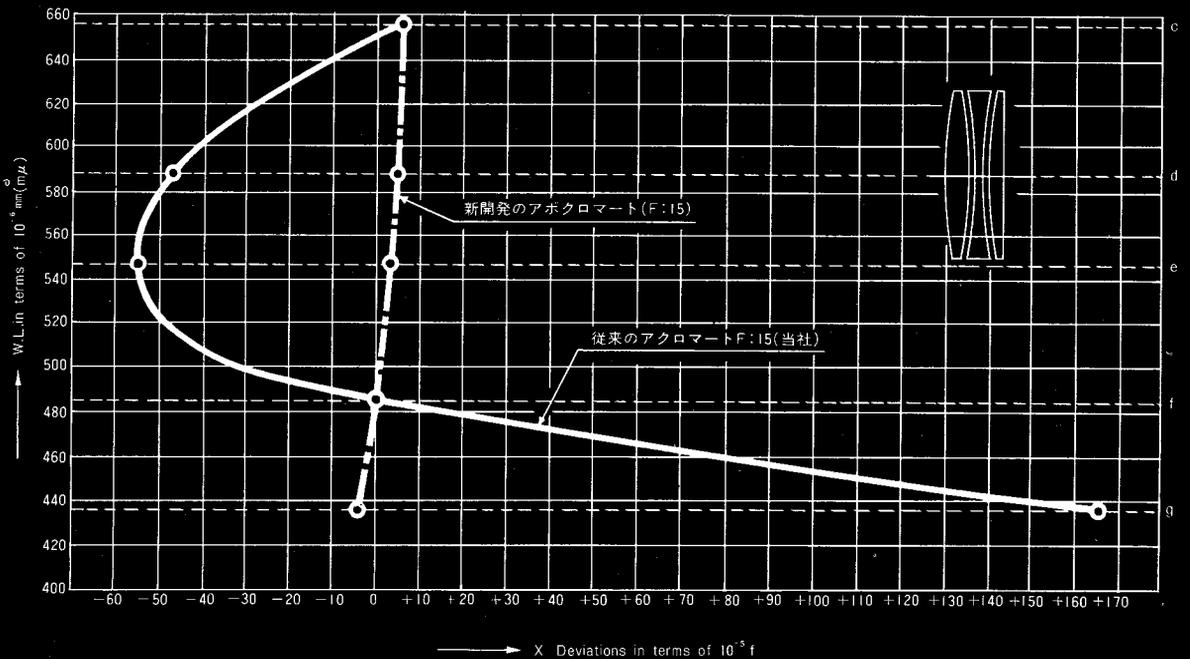
色消レンズが日本で製作されて、すでに半世紀。でも、完璧なアポクロマトとなると、計算や理論上では可能でも実際には実現不可能とさえ言われていました。3枚のレンズを枠に納めた時の芯出し精度、面精度、ホモジニティ(均質度)などに、想像を絶する精度が要求されるからです。これらの難問を五藤光学がはじめて打破
