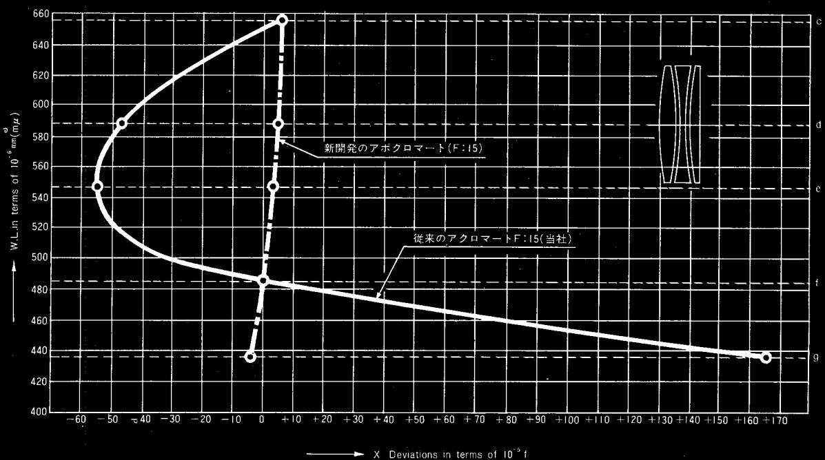
色消レンズが日本で製作されて、すでに半世紀。でも、完璧なアポクロマートとなると、計算や理論上では可能でも実際には実現不可能とさえ言られていました。3枚のレンズを枠に納めた時の芯出し精度、面精度、ホモジニティ(均質度)などに、想像を絶する精度が要求されるからです。これらの難問を五藤光学がはじめて打破
