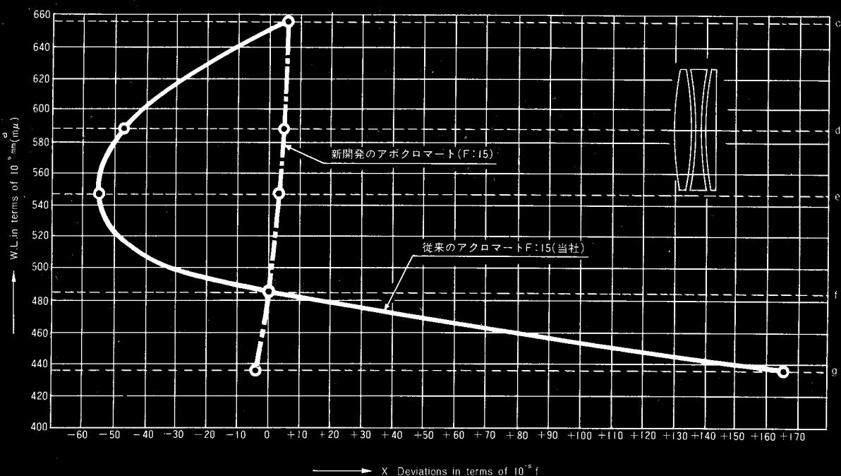
色消レンズが日本で製作されて、すでに半世紀。でも、完璧なアポクロマートとなると、計算や理論上では可能でも実際には実現不可能とさえ言わっていました。3枚のレンズを枠に納めた時の芯出し精度、面精度、ホモジニティ(均質度)などに、想像を絶する精度が要求されるからです。これらの難問を五藤光学がはじめて打破
