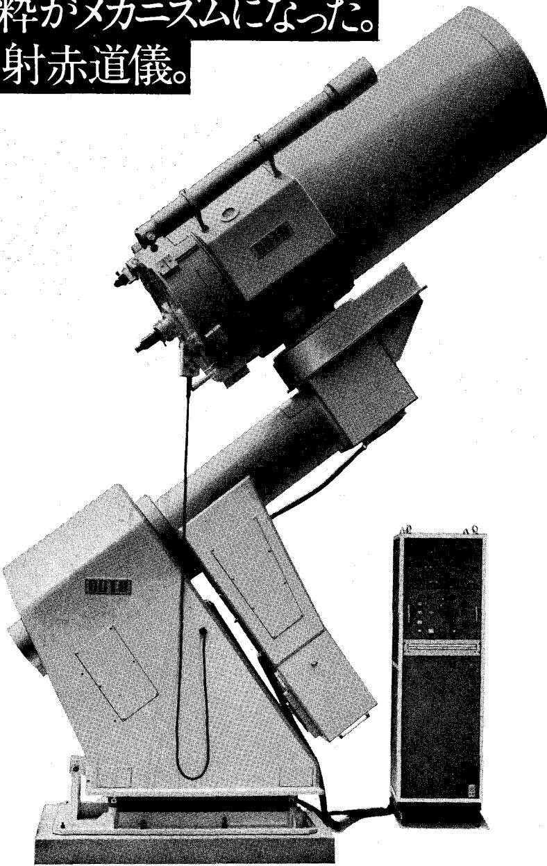
反射望遠鏡も60cmクラスともなりますと、機械が非常に大型化してくるため、30~40cmクラスのメカニズムを単に大型化しただけでは安定性にとぼしく、また、非常に使いづらい機械となってしまいます。五藤光学の60cm反射赤道儀はこの点を考慮し、従来のメカニズムを超えた新しいアイデアが各部に生かされています。例えばコントローラ・コンソール。天体の位置がすべてデジタル表示されており、3種類のスピードで
