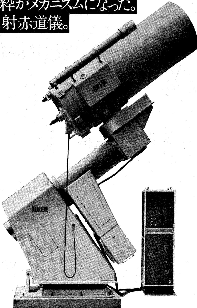
反射望遠鏡も60cmクラスともなりますと、機械が非常に大型化してくるため、30~40cmクラスのメカニズムを単に大型化しただけでは安定性にとぼしく、また、非常に使いづらい機械となってしまいます。五藤光学の60cm反射赤道儀はこの点を考慮し、従来のメカニズムを超えた新しいアイデアが各部に生かされています。例えばコントロールコンソール。天体の位置がすべてデジタル表示されており、3種類のスピードで
