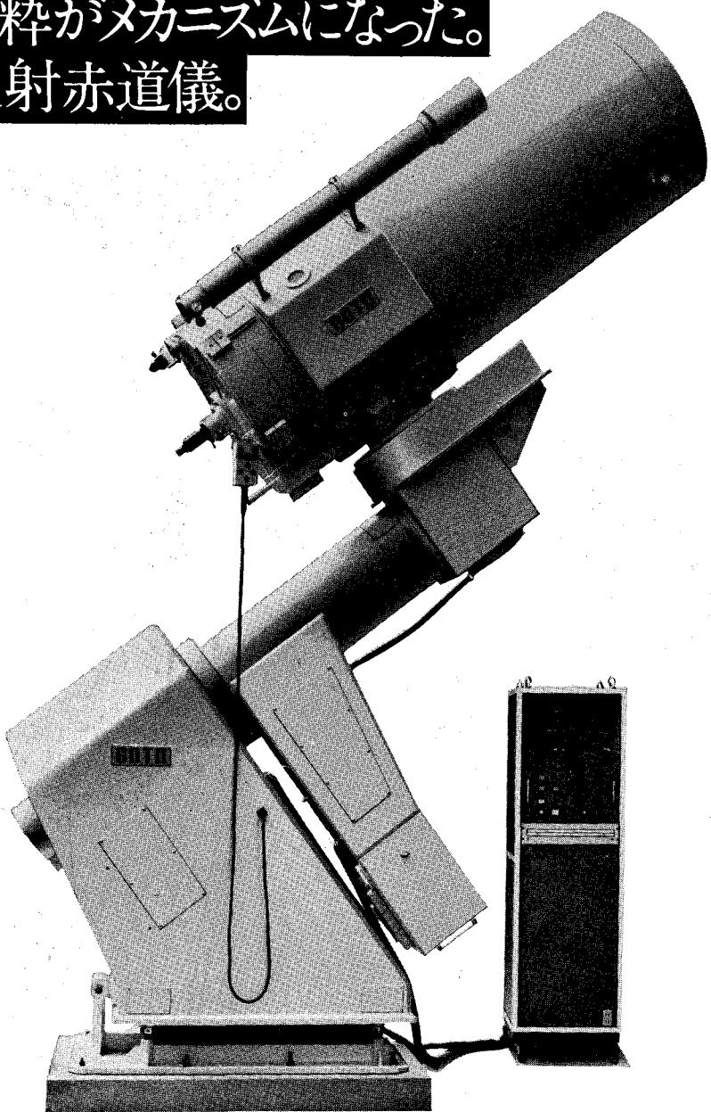
反射望遠鏡も60cmクラスとなりますと、機械が非常に大型化するため、30～40cmクラスのメカニズムを単に大型化しただけでは安定性にとぼしく、また、非常に使いづらい機械となってしまいます。五藤光学の60cm反射赤道儀はこの点を考慮し、従来のメカニズムを超えた新しいアイデアが各部に生かされています。例えばコントローラ・コンソール。天体の位置がすべてデジタル表示されており、3種類のスピードで
