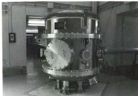
図1 (a) 20mのファブリーペロー式干渉計用真空槽
