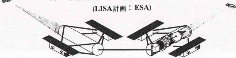
周波数雑音、散乱光、機械性雑音、熱雑音などとの戦いである。レーザー干渉計の場合、アーム長を増やし、レーザー光の強度をあげることによって感度が向上することが、レーザー技術のめざましい発展に支えられて実現に大きな期待が寄せられている。
