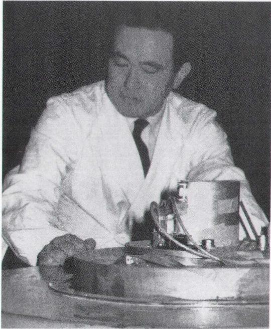
振動試験機でロケット搭載装置の試験をする小田先生。
