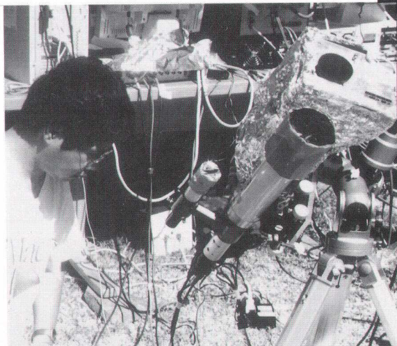
図8 アルミホイルで作成したボックス内に分光器が入っている。
