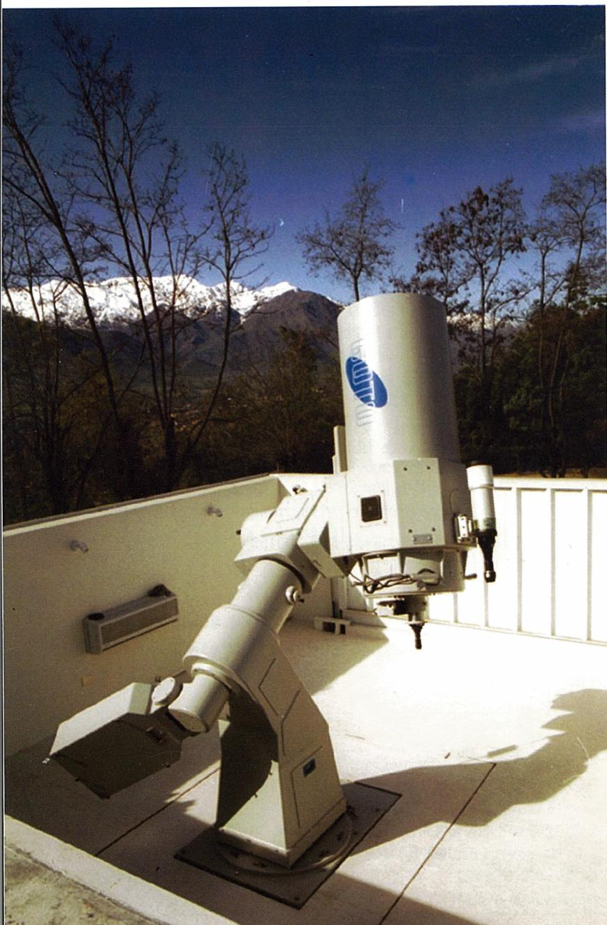
峻厳なアンデス山脈を間近に望む、南米チリの首都サンティアゴ。日本からは地球の反対側に位置し、大航海時代に「世界の果て」と言われたこの地で見る星空は、いったいどんな景色なのでしょうか？そんなロマンを一層かきたてるのが、2002年11月から国立チリ大学で始動する五藤光学の45cmカセグレン反射式赤道儀です。宇宙を見つめる研究者のために開発され、光学系では極限まで研磨された口径45cmの望遠鏡に、リモート操作が可能な先進システム「CATS-III」を搭載。あらかじめ観測撮影予約をしておけば、冷却CCDカメラを利用して自動的に見たい天体を検索・撮影できるなど、時間の制約なしにリアルな天体情報をキャッチすることができます。地球の反対側に届けられた、一台の望遠鏡。海を越えて根づく種子のように、学生たちの探求心に応え、天文学研究の新たな一步として期待されています。
