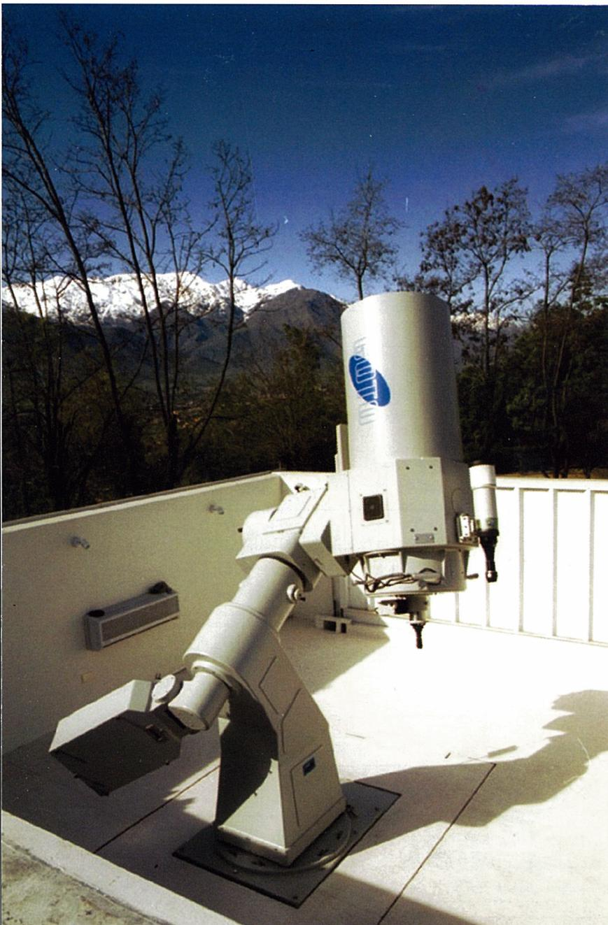
峻厳なアンデス山脈を間近に望む、南米チリの首都サンチャゴ。日本からは地球の反対側に位置し、大航海時代に「世界の果て」と言わされたこの地で見る星空は、いったいどんな景色なのでしょうか？そんなロマンを一層かきたてるのが、2002年11月から国立チリ大学で始動する五藤光学の45cmカセグレン反射式赤道儀です。宇宙を見つめる研究者のために開発され、光学系では極限まで研磨された口径45cmの望遠鏡に、リモート操作が可能な先進システム「CATS-III」を搭載。あらかじめ観測撮影予約をしておけば、冷却CCDカメラを利用して自動的に見たい天体を検索・撮影できるなど、時間の制約なしにリアルな天体情報をキャッチすることができます。地球の反対側に届けられた、一台の望遠鏡。海を越えて根づく種子のように、学生たちの探求心に応え、天文学研究の新たな一步として期待されています。
