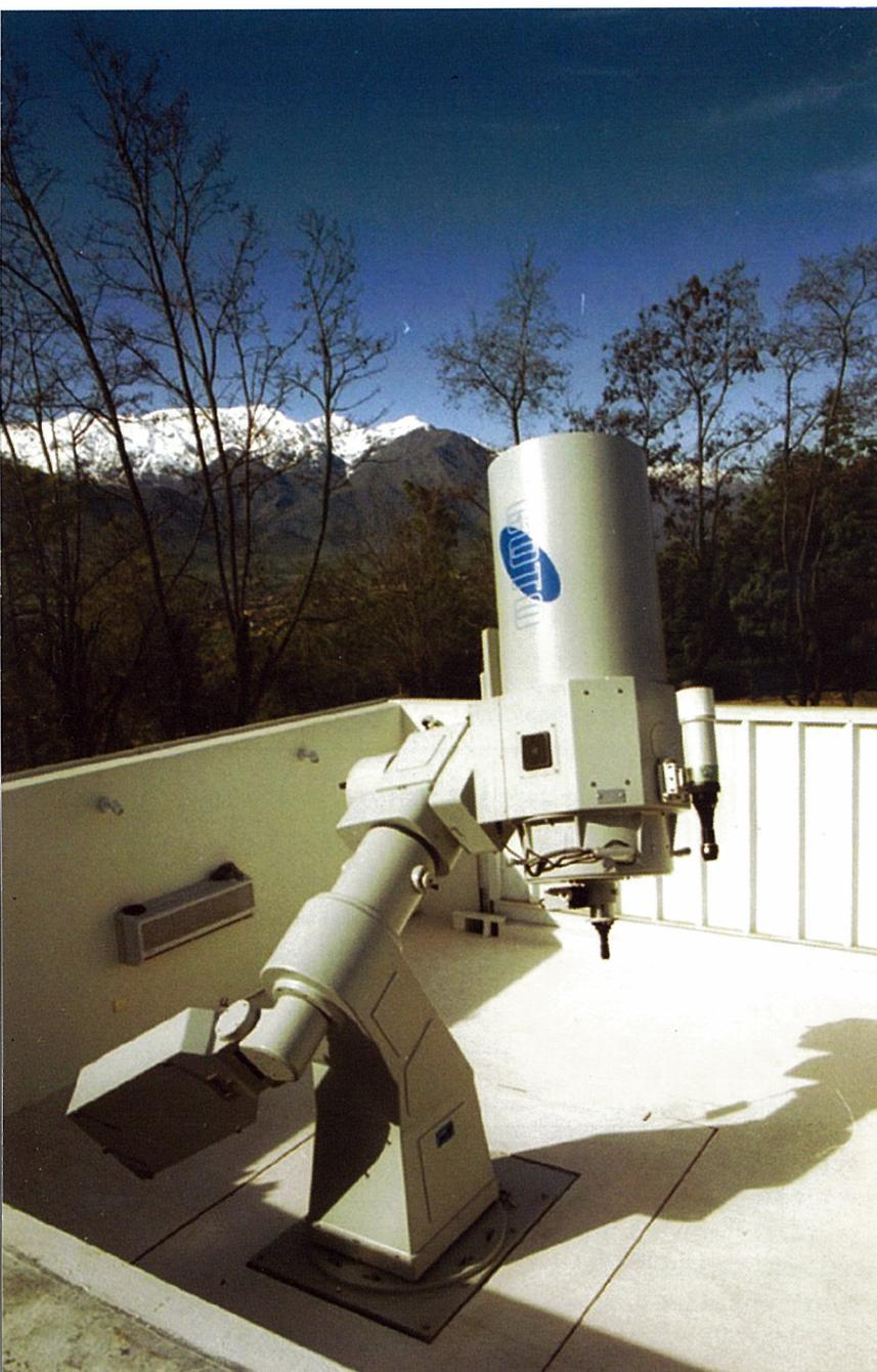
峻厳なアンデス山脈を間近に望む、南米チリの首都サンチアゴ。日本からは地球の反対側に位置し、大航海時代に「世界の果て」と言われたこの地で見える星空は、いったいどんな景色なのでしょう。そんなロマンを一層かきたてるのが、2002年11月から国立チリ大学で始動する五藤光学の45cmカセグレ反射式赤道儀です。宇宙を見つめる研究者のために開発され、光学系では極限まで研磨された口径45cmの望遠鏡に、リモート操作が可能な先進システム「CATS-III」を搭載。あらかじめ観測撮影予約をしておけば、冷却CCDカメラを利用して自動的に見たい天体を検索・撮影できるなど、時間の制約なしにリアルな天体情報をキャッチすることができます。地球の反対側に届けられた、一台の望遠鏡。海を越えて根づく種子のように、学生たちの探求心に応え、天文学研究の新たな一步として期待されています。
