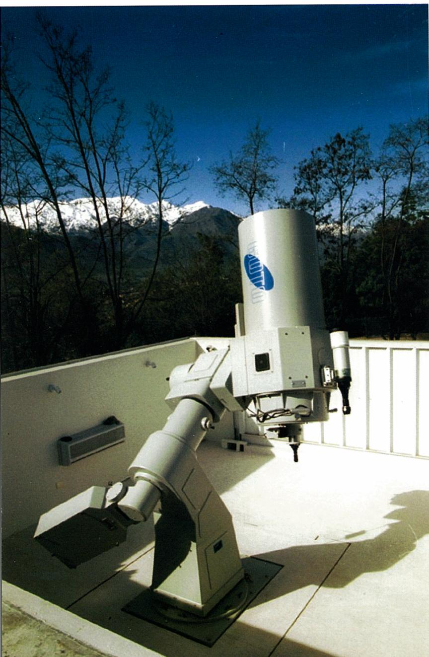
峻厳なアンデス山脈を間近に望む、南米チリの首都サンチャゴ。日本からは地球の反対側に位置し、大航海時代に「世界の果て」と言われたこの地で見る星空は、いったいどんな景色なのでしょうか？そんなロマンを一層かきたてるのが、2002年11月から国立チリ大学で始動する五藤光学の45cmカセグレン反射式赤道儀です。宇宙を見つめる研究者のために開発され、光学系では極限まで研磨された口径45cmの望遠鏡に、リモート操作が可能な先進システム「CATS-III」を搭載。あらかじめ観測撮影予約をしておけば、冷却CCDカメラを利用して自動的に見たい天体を捜索・撮影できるなど、時間の制約なしにリアルな天体情報をキャッチすることができます。地球の反対側に届けられた、一台の望遠鏡。海を越えて根づく種子のように、学生たちの探求心に応え、天文学研究の新たな一步として期待されています。
