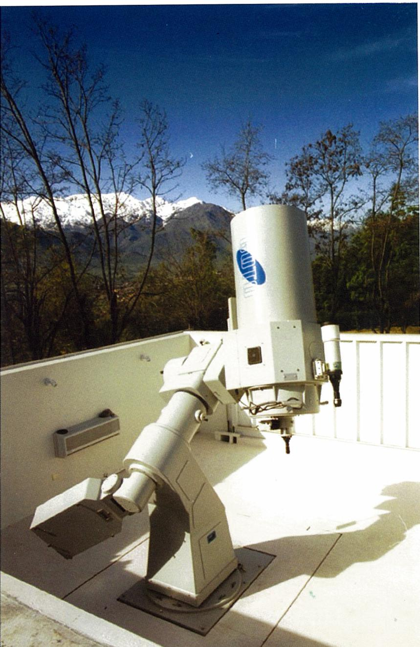
峻厳なアンデス山脈を間近に望む、南米チリの首都サンチャゴ。日本からは地球の反対側に位置し、大航海時代に「世界の果て」と言われたこの地で見る星空は、いったいどんな景色なのでしょうか？そんなロマンを一層かきたてるのが、2002年11月から国立チリ大学で始動する五藤光学の45cmカセグレン反射式赤道儀です。宇宙を見つめる研究者のために開発され、光学系では極限まで研磨された口径45cmの望遠鏡に、リモート操作が可能な先進システム「CATS-Ⅲ」を搭載。あらかじめ観測撮影予約をしておけば、冷却CCDカメラを利用して自動的に見たい天体を検索・撮影できるなど、時間の制約なしにリアルな天体情報をキャッチすることができます。地球の反対側に届けられた、一台の望遠鏡。海を越えて根づく種子のように、学生たちの探求心に応え、天文学研究の新たな一步として期待されています。
