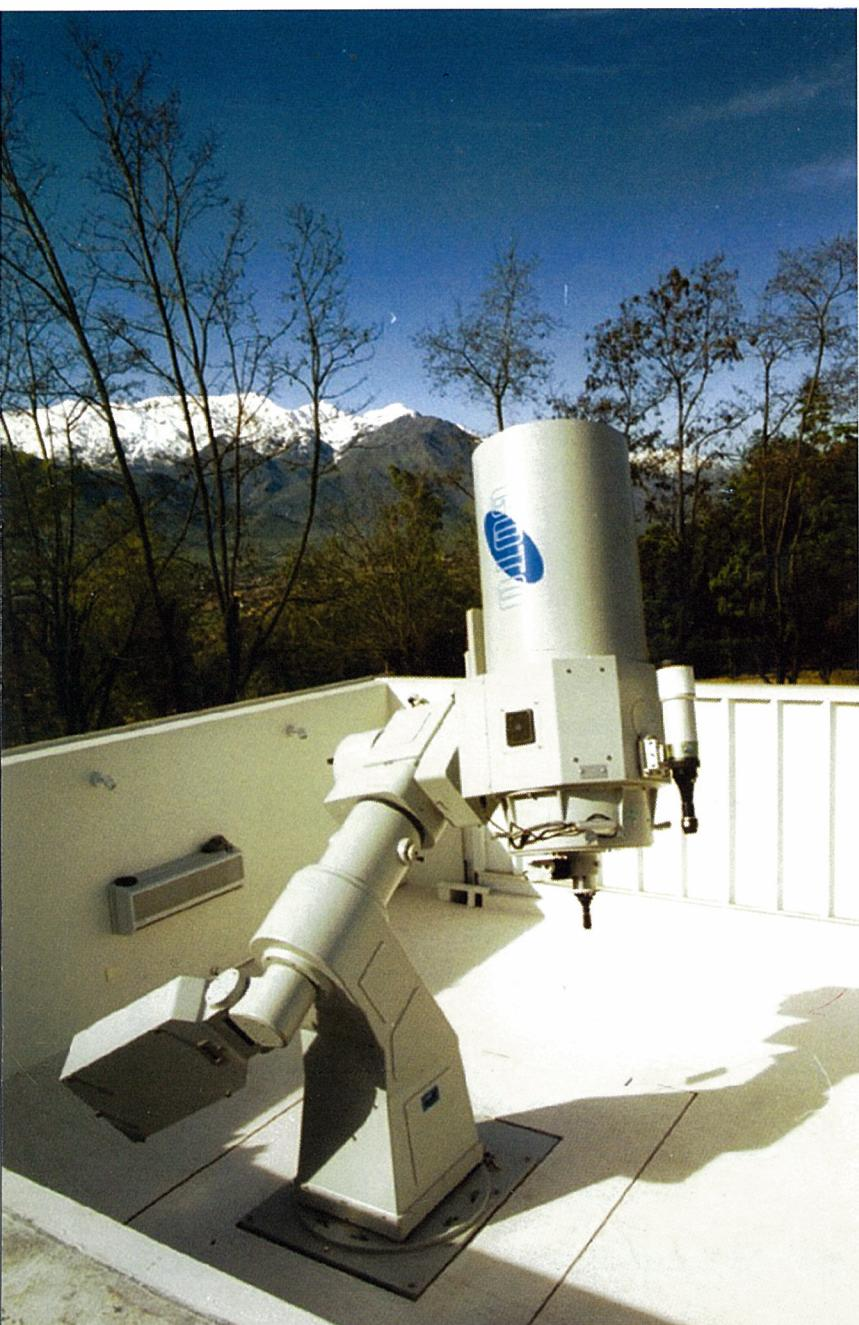
峻厳なアンデス山脈を間近に望む、南米チリの首都サンチャゴ。日本からは地球の反対側に位置し、大航海時代に「世界の果て」と言われたこの地で見る星空は、いったいどんな景色なのでしょうか？そんなロマンを一層かきたてるのが、2002年11月から国立チリ大学で始動する五藤光学の45cmカセグレン反射式赤道儀です。宇宙を見つめる研究者のために開発され、光学系では極限まで研磨された口径45cmの望遠鏡に、リモート操作が可能な先進システム「CATS-II」を搭載。あらかじめ観測撮影予約をしておけば、冷却CCDカメラを利用して自動的に見たい天体を捜索・撮影できるなど、時間の制約なしにリアルな天体情報をキャッチすることができます。地球の反対側に届けられた、一台の望遠鏡。海を越えて根づく種子のように、学生たちの探求心に応え、天文学研究の新たな一步として期待されています。
