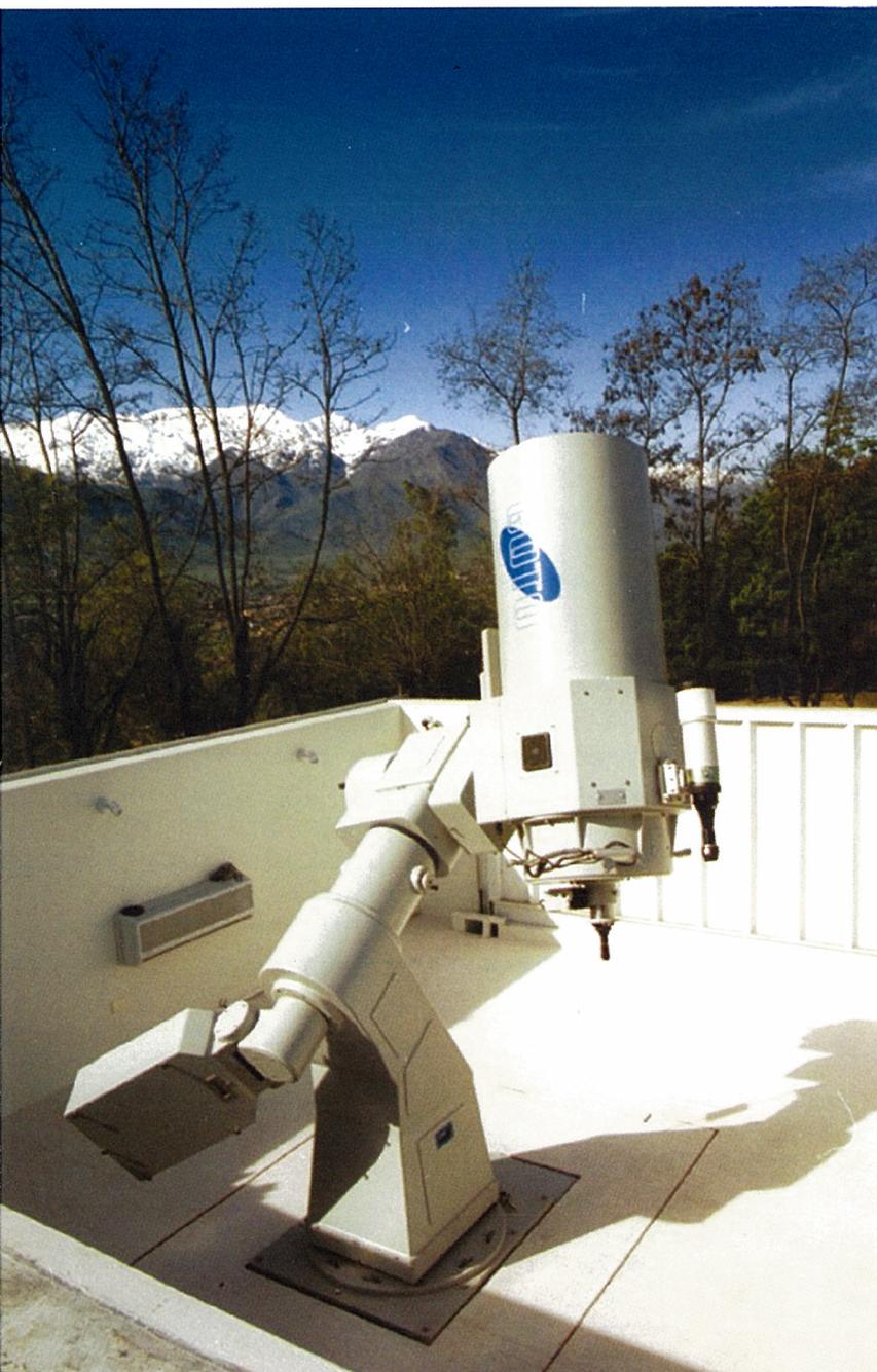
峻厳なアンデス山脈を間近に望む、南米チリの首都サンチアゴ。日本からは地球の反対側に位置し、大航海時代に「世界の果て」と言われたこの地で見る星空は、いったいどんな景色なのでしょう？そんなロマンを一層かきたてるのが、2002年11月から国立チリ大学で始動する五藤光学の45cmカセグレ反射式赤道儀です。宇宙を見つめる研究者のために開発され、光学系では極限まで研磨された口径45cmの望遠鏡に、リモート操作が可能な先進システム「CATS-Ⅲ」を搭載。あらかじめ観測撮影予約をしておけば、冷却CCDカメラを利用して自動的に見たい天体を搜索・撮影できるなど、時間の制約なしにリアルな天体情報をキャッチすることができます。地球の反対側に届けられた、一台の望遠鏡。海を越えて根づく種子のように、学生たちの探求心に応え、天文学研究の新たな一步として期待されています。
