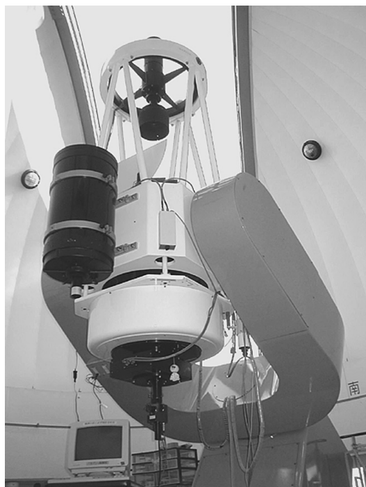
写真1 西はりま天文台の 60 cm 望遠鏡。カセグレン焦点に装着されているのは、光電測光器 (ひごい)。
