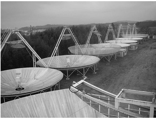
図1 30m電波望遠鏡の上から見た真冬の那須パルサー観測所の様子。2基のアンテナの周りに網が張られているのは大地からの熱雑音などが入り込んでくるのを防ぐためである。他のアンテナにも順次張っていく予定。
