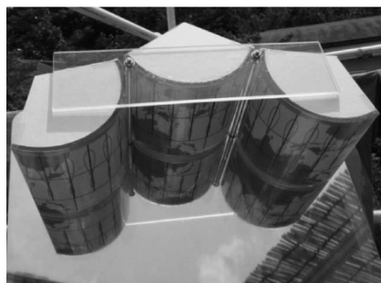
図6 時間分割をした円筒型日時計。
