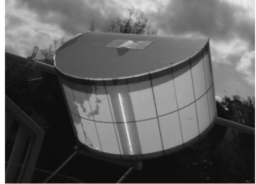
図 16 シリカエアロゲルの円筒レンズを利用した日時計。
