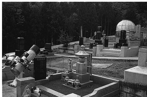
写真2 お墓の中の天文台。右側は2.5 m 手作り観測ドーム20 cm ツイン反射望遠鏡が入っていた。左下は1990年から使用した30 cm ε 反射望遠鏡。
