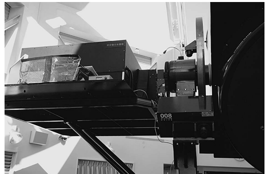
写真5 ナスミス台上のSNS中分散分光器。
