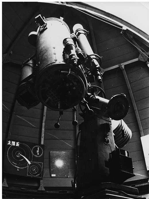
写真1 開台頃の41 cm 反射望遠鏡。左側の短く太めなのが20 cm f5 パーキンエルマー写真レンズ。
