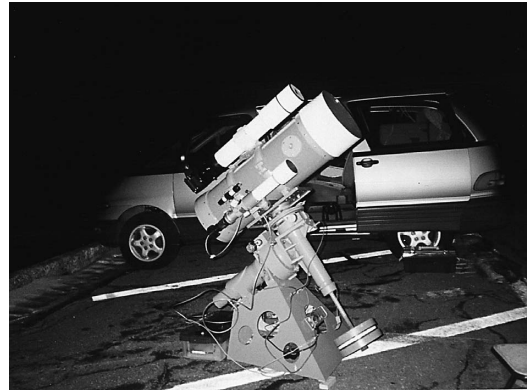
図3 自作架台に載せたタカハシε250。
