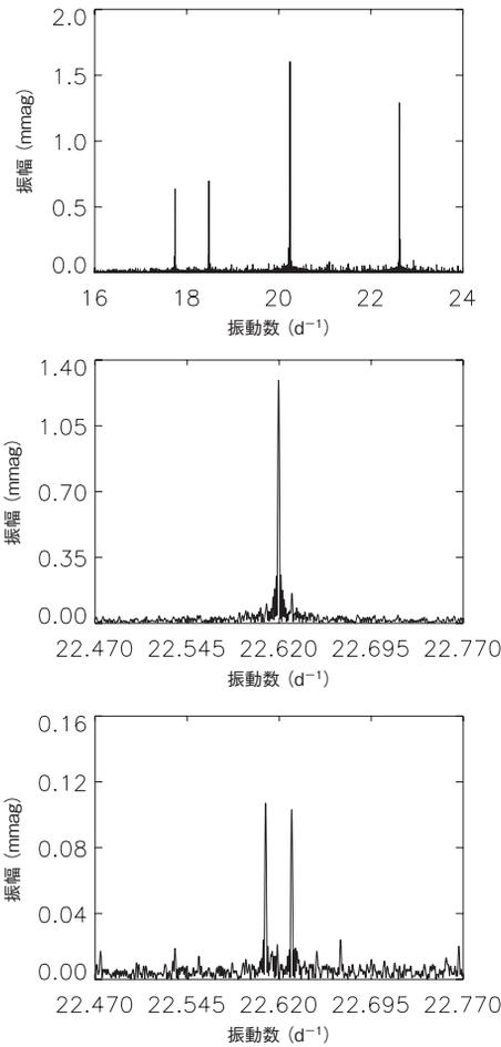
図3 KIC 4150611中の振動スペクトル. 上段: 四つのモードの存在を示す. 中段: 22.6196 d<sup>-1</sup>のモードの拡大図. 三重構造の微細構造が見られる. 下段: 22.6196 d<sup>-1</sup>のモードの中央のピークをプレホワイトニングした結果. 三重項の両端のピークは等振幅であることを示す. 文献3から転載.
