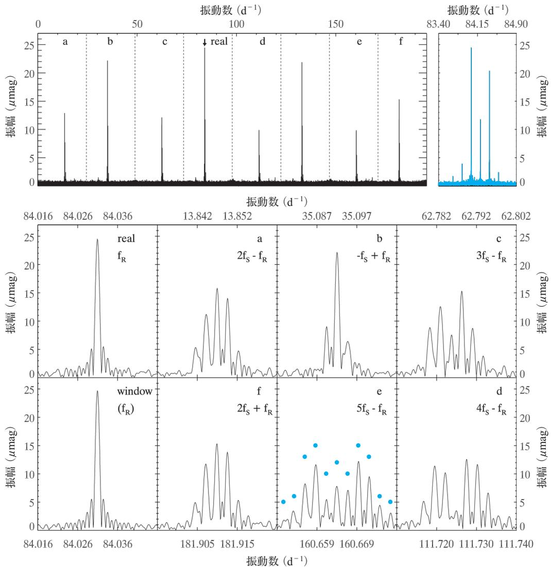
図8 上段: KIC 10195926のLCデータ(左)とSCデータ(右)のフーリエ・スペクトル. 下段: 'real'と'a'-'f'の拡大図. 'real'はナイキスト周波数よりはるかに高いが, 単独ピークであるので真の振動数. 'a'は $2\nu_S - \nu_0$ の折返し偽信号の五重項, 'b'は $-\nu_S + \nu_0$ の三重項, 'c'は $3\nu_S - \nu_0$ の七重項, 'd'は九重項, 'e'は十一重項, 'f'は $2\nu_S + \nu_0$ の折返し偽信号の五重項の微細構造で, いずれもデータが離散的であるがゆえに生じる折返し偽信号である. 文献4から転載.
