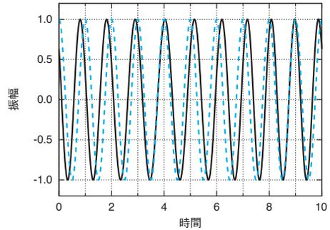
図2 位相が周期的に変化している振動の概念図。破線は、位相が一定の場合の正弦波。黒線が、位相が周期的に変化している場合。文献3から転載。
