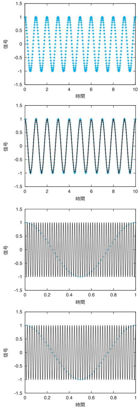
図5 最上段の図のような離散的な観測データがあれば、2段目の図のような周期関数と思うかもしれないが、3段目の図や最下段の図の周期関数にも矛盾なくフィットするので唯一的には決められない。実際、フーリエ・スペクトルは図6に示すように、周波数以外は無数個のピークがある。
