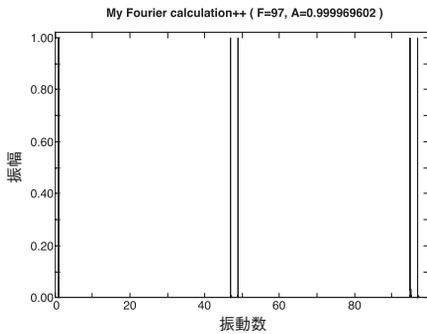
図6 図5最上段パネルに示した離散データのフーリエ・スペクトルは図に示すように、周波数以外は同等なピークが無数個ある。
