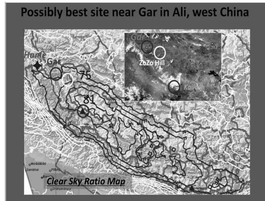
図4 気象衛星データから求めたアリ地区周辺の晴天率分布図<sup>5)</sup>で、濃い色のコントアは晴天率75%以上を示す。右上の挿入図は晴天率分布図に対応する地形図（Google Earth）。現在の調査サイト・ガー山（Gar）を濃い円、調査を検討しているZoZoHillを白い円で示している。比較のために近くにある高山（Peak #1, Peak #2）を薄い円で、またカイラス山を濃い円内の▲で示した。ガー山からZoZoHillまでは直線距離90 km。図中左に示している Hanle は2 m望遠鏡を有するハンレ観測所（インド）。
