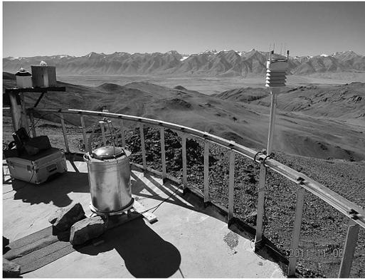
図5 ガー山(5,036 m)サイト調査用10 mタワー屋上に設置された雲モニター装置と気象センサー。左側2台のカメラは姚教授らによる可視光全天カメラ。奥の山の向こうには古代遺跡グゲ、さらにその奥にヒマラヤ山脈がある。
