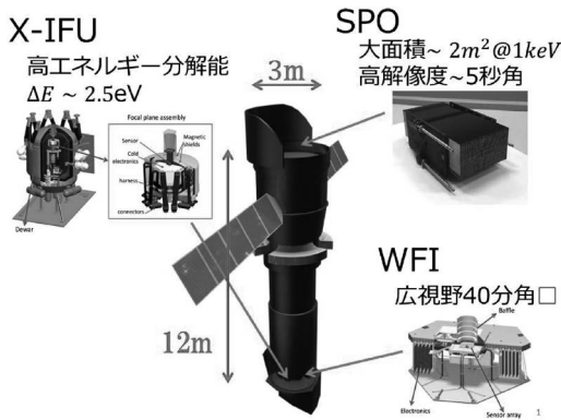
図1 X線天文衛星 Athenaとその搭載機器.
