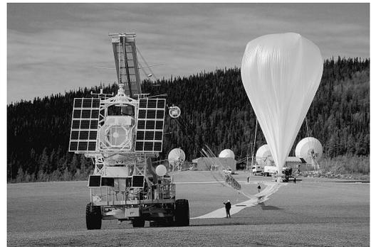
図3 SUNRISE高高度大型気球実験。手前に見えるのがゴンドラ部で、1 m口径の望遠鏡を搭載している。
