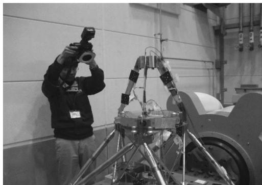
図5 小型JASMINEの望遠鏡の試作試験用モデル（ブレッドボードモデル相当）。熱構造の試験用モデルも兼ねる。
