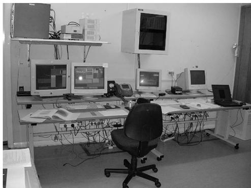
図4 40インチ望遠鏡の観測室(筆者撮影)。左二つのモニターを通じて、望遠鏡とカメラを制御する。
