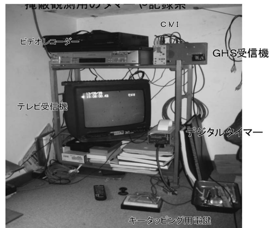
写真2 ビデオカメラからのレコーダ，タイムインポーサ，監視テレビなどの私の観測体制。
