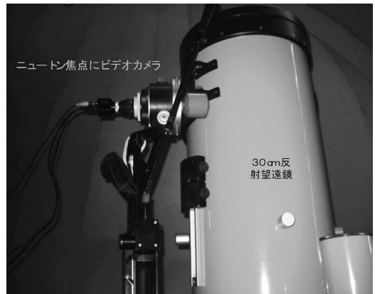
写真1 30 cm 反射望遠鏡の焦点にビデオカメラを付ける。
