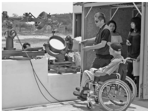
写真6 2018年1月末、かつてワンカイヨ観測所にて使用されていたシーロスタットに京大から輸送した高精度平面鏡を搭載。その性能が蘇りつつある様子を確認される石塚先生。
