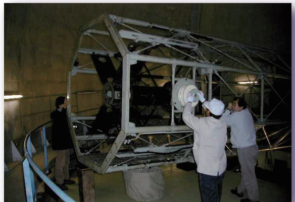
図 10 188 cm 望遠鏡装置交換時のバランス調整作業（1999 年 12 月）。撮影：富田晃彦。
